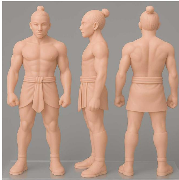
Gambar 5. Prototipe Badang PLA 75 mm, tampak ¾; layer-height 0,1 mm (sumber:Pribadi)
